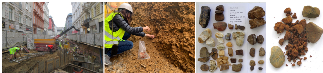
Sedimentbeprobung in der offenen Baugrube im Kreuzungsbereich Kirchen-/Lindengasse. Die Kieskomponenten bestehen vor allem aus Sandsteinen der Flyschzone. Die Feinfraktion des Plattelschotters ist rot, die Grobfraktion nicht.
