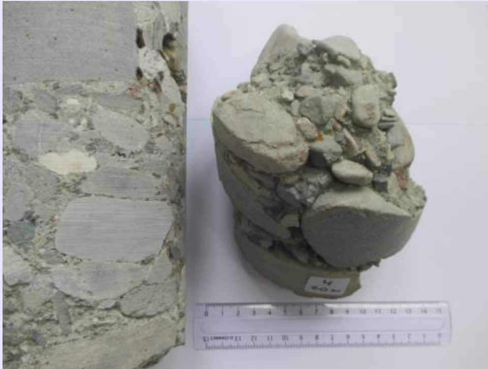
karbonatisch zementierte Konglomerate / Brekzien (MEWA, Hütteldorfer Straße 130)
